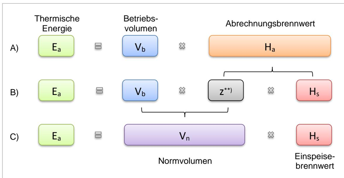
**\*\*)  $z$  = Zustandszahl:** Sie dient der Korrektur von temperatur- und druckbedingten Einflussfaktoren. Die Ermittlung der Zustandszahl  $z$  und des Einspeisebrennwertes  $H_s$  ist im Abschnitt 4 detailliert beschrieben.
